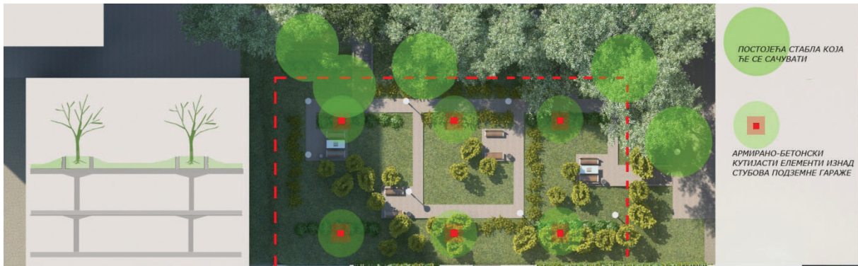
Слика бр. 1 - шематски приказ уређења озелењеног кровног врта над подземним гаражама са пресеком бетонских када изнад носећих конструктивних елемената.
